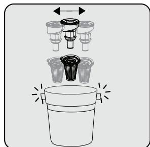
Buang debu pada pra-filter dan filter plastik dengan cara mengetukkannya pada permukaan yang keras seperti tempat sampah atau dengan memakai sikat.
